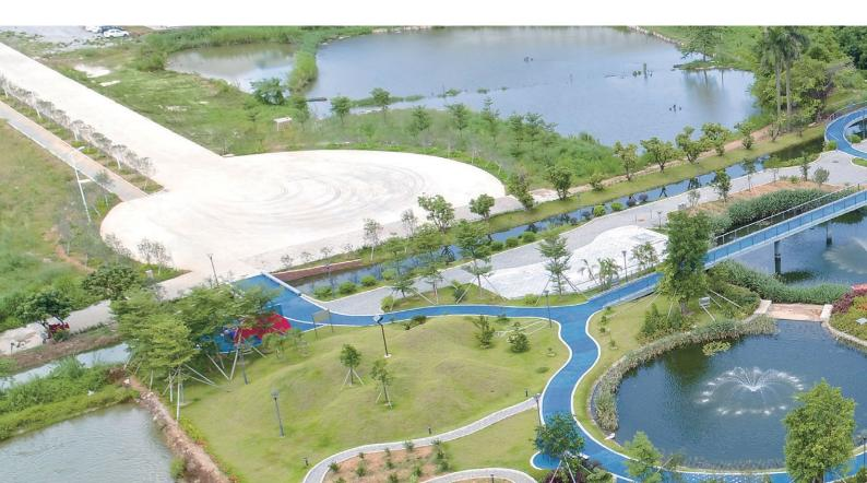
在建築上如何提高用水效率、污水處理與排放是LEED 另一重要考慮標準。新會生產基地設有污水處理設 施、中水回用系統及高效節水器具,可以最大程度節 約用水。為了進一步淨化在廠房排放的污水,李錦記 正在新會生產基地興建佔地約16,000平方米的人工濕 地公園,目前濕地公園的整體結構已大致完成,現正 進行植物的培植及系統調試,預計於明年1月正式投入 運作。通過在人工濕地種植特定的植物以減少污水中 的氮化物,每日的污水處理量達4,000立方米。
